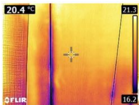
Lucht die uit de muurisolatie komt, tussen de planken door
