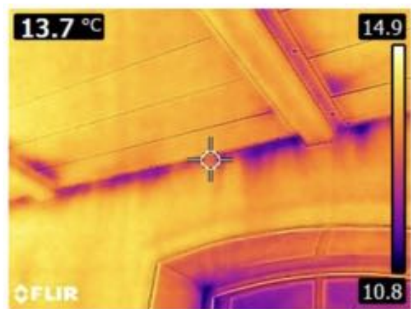
Koude lucht uit het plafond stroomt langs de muur naar binnen.
