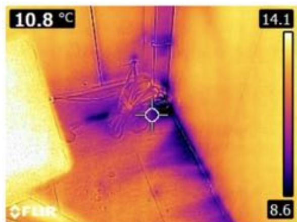
Koude lucht vanuit de nu nog koude ruimte in het vierkant stroomt over de vloer
