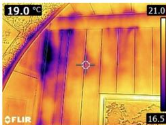
Koude lucht uit het plafond / open ruimte naar de etage
