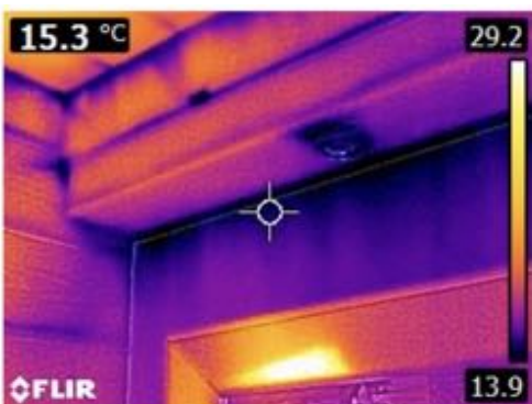
De aftimmering in de garderobe heeft op een of andere manier open verbindingen met de buitenlucht / zolder
